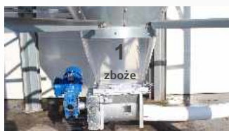
dozownik ziarna podłączony pod silos
