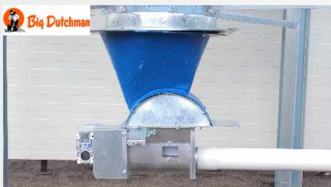
Big Dutchman montuje się pod łącznikiem z zasuwą kosza (wywiercić 2 otwory w łączniku)
